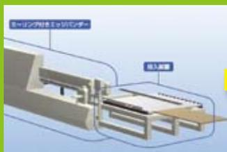
**01** 投入装置へ1回目のパネル投入。片側からミーリング&縁貼り加工します。
